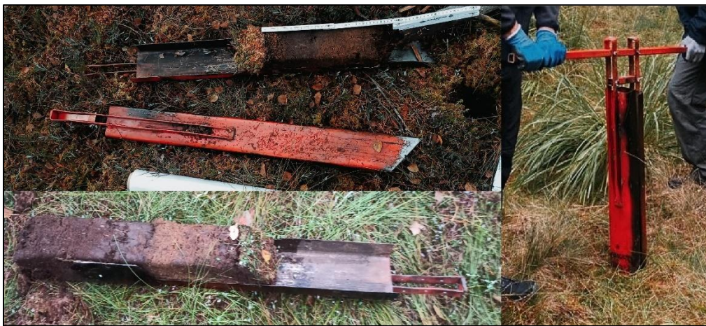
Fig. 1 Prelevatorul cuboid utilizat pentru colectarea probelor și coloane de turbă extrase cu ajutorul acestuia
